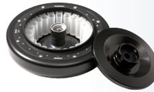
**Rotor oscilante, 24-posiciones, con tapa biológicamente estanca y resistente al fenol n= 13,000 min<sup>-1</sup>, RCF máx 18,327,**
