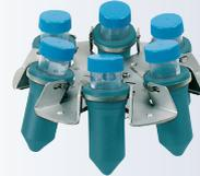
**Rotor oscilante, 6-pos., para 6 x tubos Falcon de 50/15ml, n= 4,000 min<sup>-1</sup>, RCF 2,701, acero.inox. con soportes PA, fibra de vidrio reforzada,**
