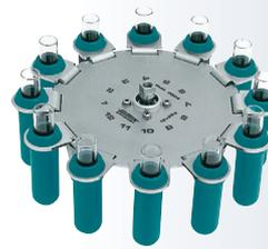
**Rotor oscilante, 12-pos. para 12 x 15 ml, n= 4,000 min<sup>-1</sup>, RCF 2,680, acero inoxidable, ilustrado con soportes No. 01621, PA, fibra de vidrio reforzada.**
