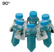
**Rotor oscilante, 6-pos., para 6 x tubos Falcon de 50/15 ml n= 4,000 min<sup>-1</sup>, RCF 2,701, acero inoxidable, con soportes, PA, fibra de vidrio reforzada.**
