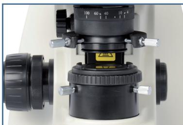
**ILUMINACIÓN KOEHLER / CONDENSADOR DE CAMPO CLARO CENTRABLE POR DESLIZAMIENTO**
