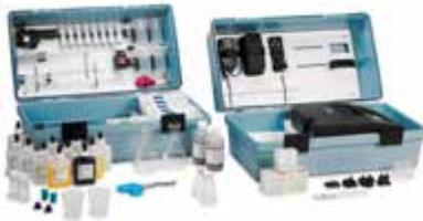
**DREL - Laboratorios configurados de fábrica para el análisis de agua profesional: fotómetro con pilas y cubetas, maletín de instrumentos, maletín de reactivos y utensilios, set de reactivos y set de instrumentos.**
