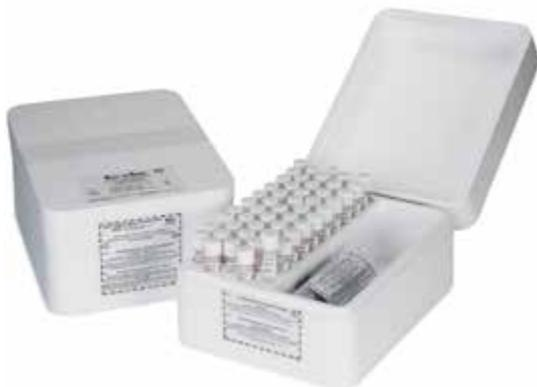
Las cubetas test TEST'N'TUBE están totalmente equipadas con todos los reactivos previamente medidos, y optimizadas para que proporcionen unos resultados de medición fiables y se manejen con facilidad. Los viales de 16 mm con tapón ofrecen un paquete completo para la mezcla y la medición. Todos los reactivos y los viales necesarios se incluyen en el paquete.
