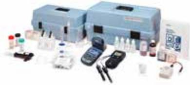
**CEL - Laboratorios configurados de fábrica para varias aplicaciones: colorímetro, set de reactivos, los aparatos necesarios, instrumentos adicionales y todos los artículos necesarios para realizar análisis sobre el terreno.**
