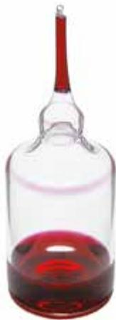
El secreto de las ampollas ACCUVAC reside en el vacío de la cubeta de vidrio sellada que contiene una cantidad medida de reactivo. El análisis se lleva a cabo sumergiendo la punta de la ampolla ACCUVAC en la muestra para, a continuación, romperla aplicando una presión moderada. El vacío aspira la muestra hacia el interior de la cubeta, garantizando al mismo que se mezcle perfectamente. El color resultante se mide visual o fotométricamente.
