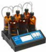
**BOD TRAK II - Estación de medida manométrica de la DBO(n) para laboratorio, unidad de control y agitador con sensores de presión electrónicos para hasta 6 botellas.**
